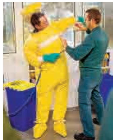
Die künstliche Atemluft kühlt: Bis zu vier Stunden arbeiten die Produktionsmitarbeiter in diesen Schutzanzügen.
